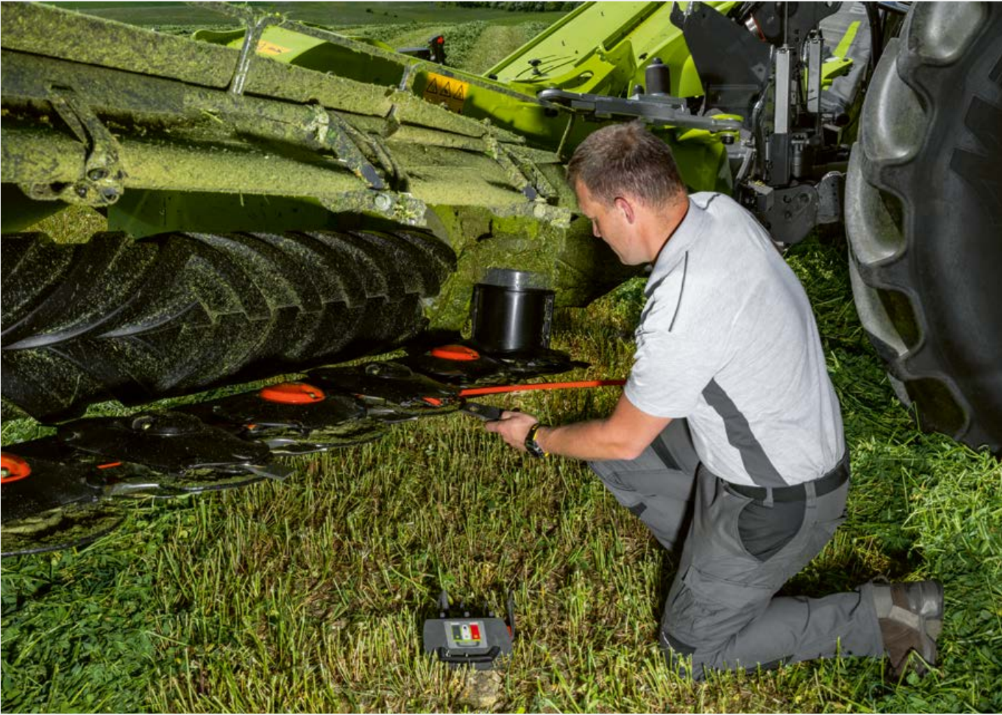
Les couteaux peuvent être remplacés aisément, directement sur la parcelle, puisque les couteaux de rechange sont immédiatement accessibles dans une boîte étanche fixée sur le lamier. L'opération peut être exécutée rapidement et sans difficultés grâce au levier de montage intégré au lamier.
