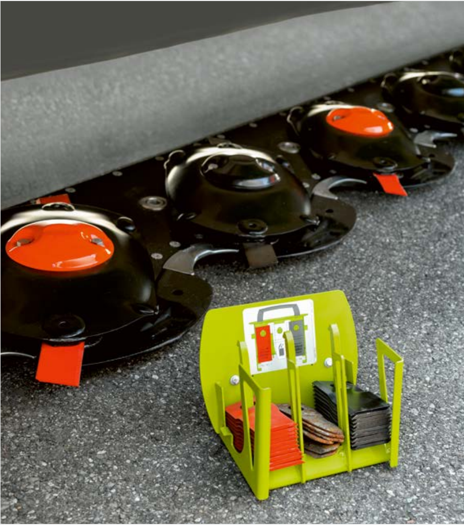
Les disques de coupe à rotation vers la gauche et les couteaux correspondants sont identifiés par une peinture rouge.
