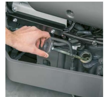
Le contrôle du niveau d'huile et l'appoint d'huile peuvent s'effectuer capot fermé sur le côté droit de l'AXOS 200.
