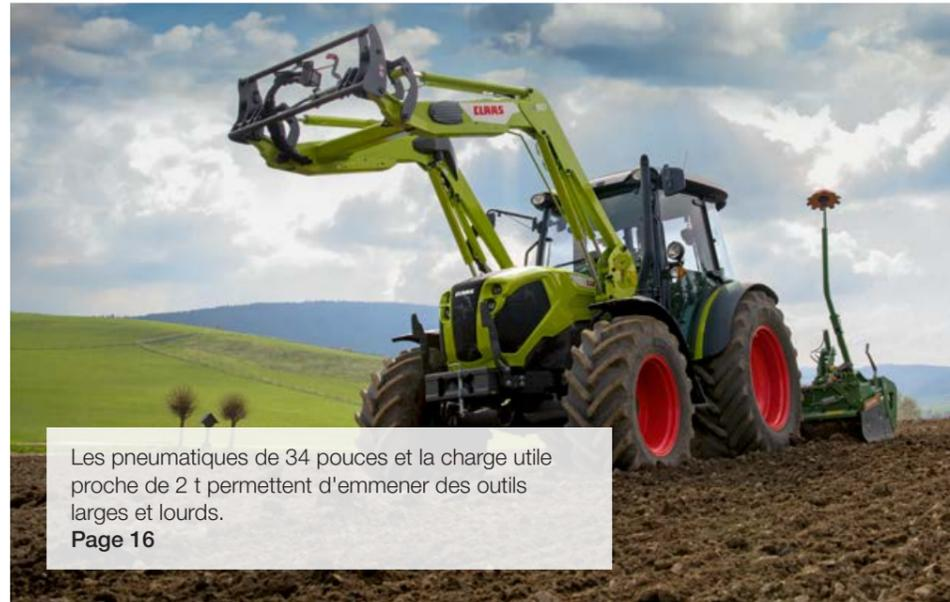
Les pneumatiques de 34 pouces et la charge utile proche de 2 t permettent d'emmener des outils larges et lourds.
