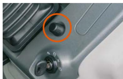
Le bouton rotatif permet de naviguer confortablement dans le menu. Il se situe à côté de la colonne de direction.
