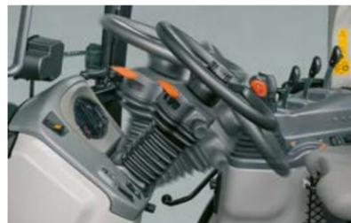
La colonne de direction réglable en inclinaison et en profondeur permet à chacun de trouver une position de conduite des plus confortables.
