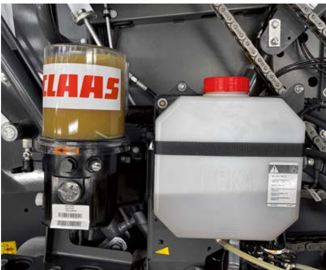
Graissage centralisé des roulements de porte.
