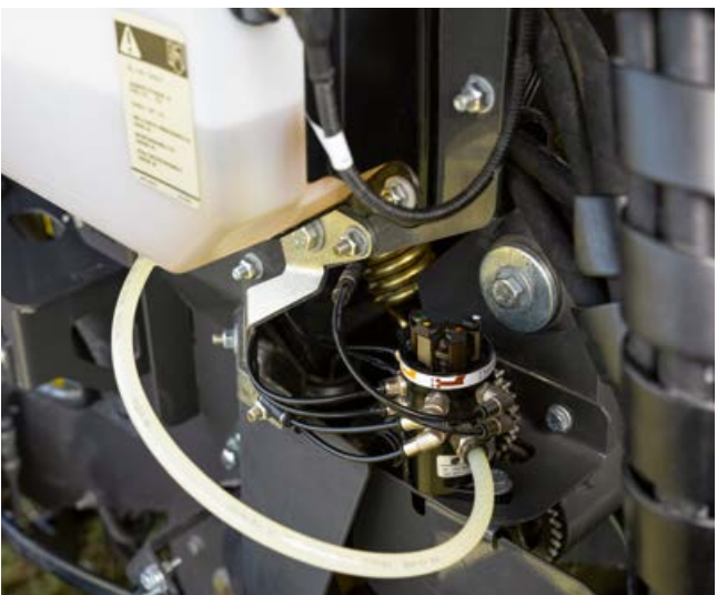
Lubrification permanente des chaînes.
