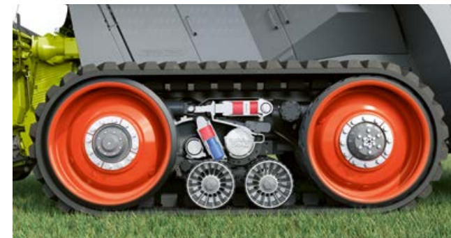
Kontakto plotas 100 %: atraminiai ritinėliai visiškai remiasi į paviršių.
