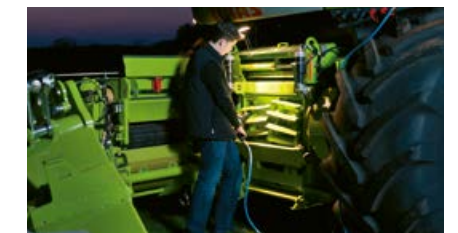
QUICK ACCESS leidžia patikrinti smulkinimo mechanizmą per kelias minutes.
