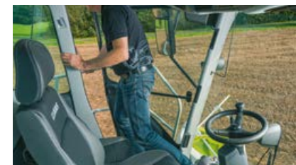
Sėdynės kontaktinis jungiklis automatiškai išjungia priekinį priedą ir pagrindinę pavarą.
