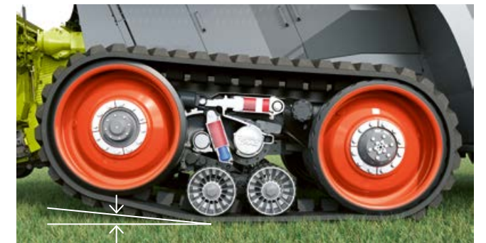
Kontakto plotas 66 %: važiuojant posūkiuose, vikšrų atraminiai ritinėliai pakelliami.
