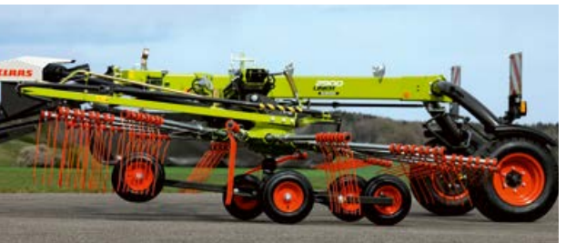
Lėktuvo efektas: rotoriai pasikelia ir nusileidžia panašiai kaip kylantis ir besileidžiantis lėktuvas.
