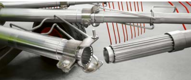
Patogus pirštų laikiklių sumontavimas ir nuėmimas: patentuota PROFIX pirštų laikiklių tvirtinimo sistema su išdrožas turinčiu sujungimu.
