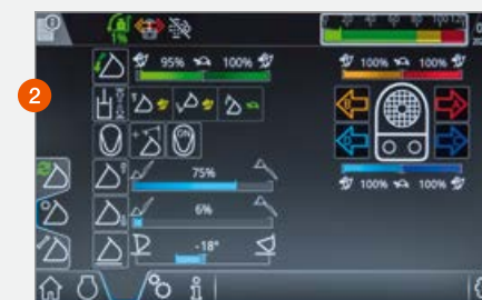
Pakėlimo ir nuleidimo aukščio ribos rodomos 9 colių jutikliniame ekrane
