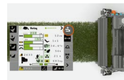
Hidraulinis PFS tiekimo ierenginis yra lengvai reguliuojamas iš traktoriaus kabinos.
