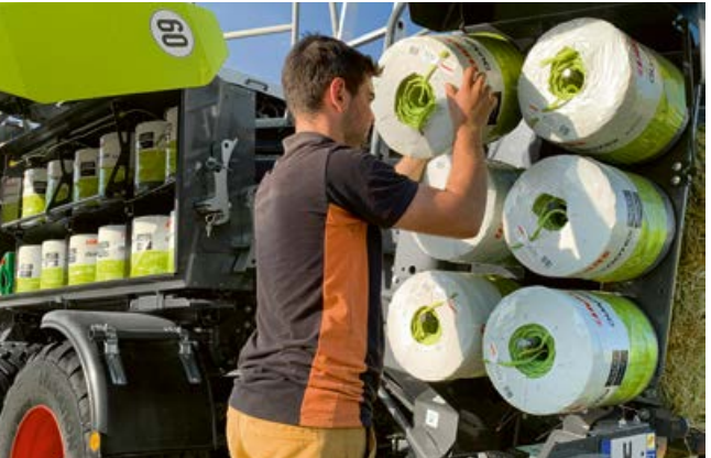
Pasirenkama: vieta 12 papildomų špagato ričių. Priklausomai nuo ryšulių dydžio, šio špagato pakanka 350–400 ryšulių.
