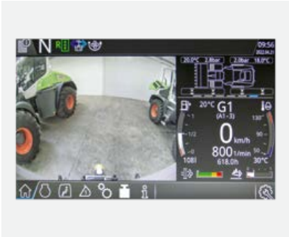
Ijungus atbulinę pavarą, iškart automatiškai įjungama galinė vaizdo kamera.
