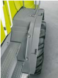
Visiems TORION vidutinio dydžio mašinų serijos modeliams galima pasirinkti visus reguliuojamus purvasaugius, kad pagerėtų ratų matomumas, ypačiai važiuojant išilgai siloso kaupio sienų.
