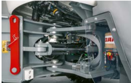
Dėl posūkio lanksto, kurio posūkio kampas yra 40°, TORION yra judrus ir manevringas.
