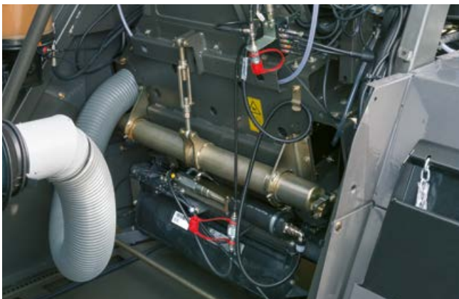
Iškrovimo greitintuvo tarpas reguliuojamas mechaniniu būdu
