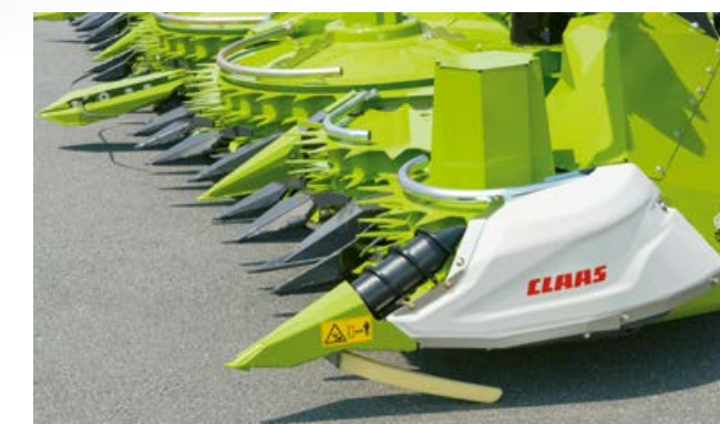
Jei reikia, gali būti sumontuotos hidraulinė pavara turinčios sraigės pagulusiems kukurūzams.
