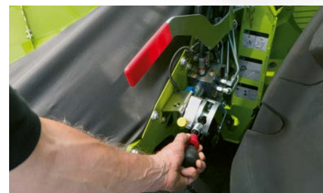
Trijų pakopų reguliuojamas tiekimo būgnų greitis, kad augalų masė būtų tiekama tolygiai.
