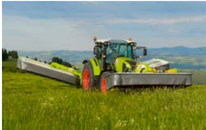
Kompaktiška priekinio pakabinimo įtaiso pakaba užtikrina didžiąją prošvaisą apsisukant galulaukėje.
