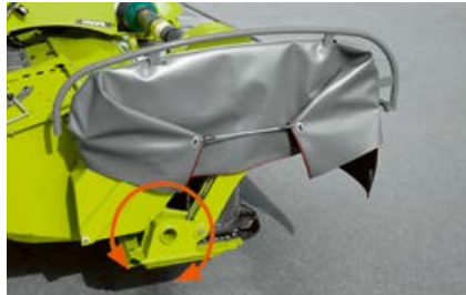
Dėl žemai esančio pasisukimo taško, DISCO PROFIL kopijuoja lauko paviršiaus nelygumus, o ne traktoriaus judesius.
