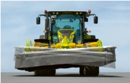
Laisvai pasisukantis tvirtinimas, skirtas prisitaikyti prie paviršiaus nelygumų skersai važiavimo krypties.
