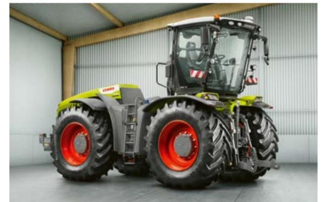
Le XERION TRAC VC dispose du dispositif à poste inversé le plus confortable du marché. Sa cabine peut pivoter à 180° en moins de 30 secondes.
