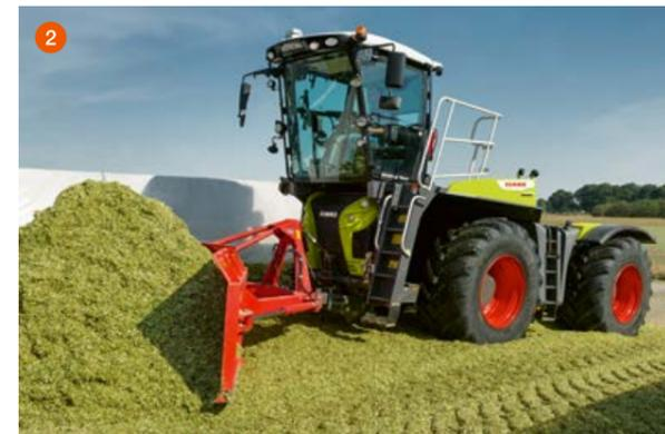
Si vous utilisez une lame montée sur le relevage avant de la version TRAC, TRAC VC ou SADDLE TRAC, vous pouvez l'équiper d'un relevage avant renforcé (2) pour pousser l'ensilage sur une largeur maximale de 4 m. Des vis de cisaillement protègent le relevage contre les surcharges.
