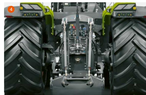
Un relevage arrière pivotant (4) est disponible sur la version SADDLE TRAC. Il permet par exemple d'épandre du lisier en marche en crabe afin de ménager les sols des parcelles fragiles.
