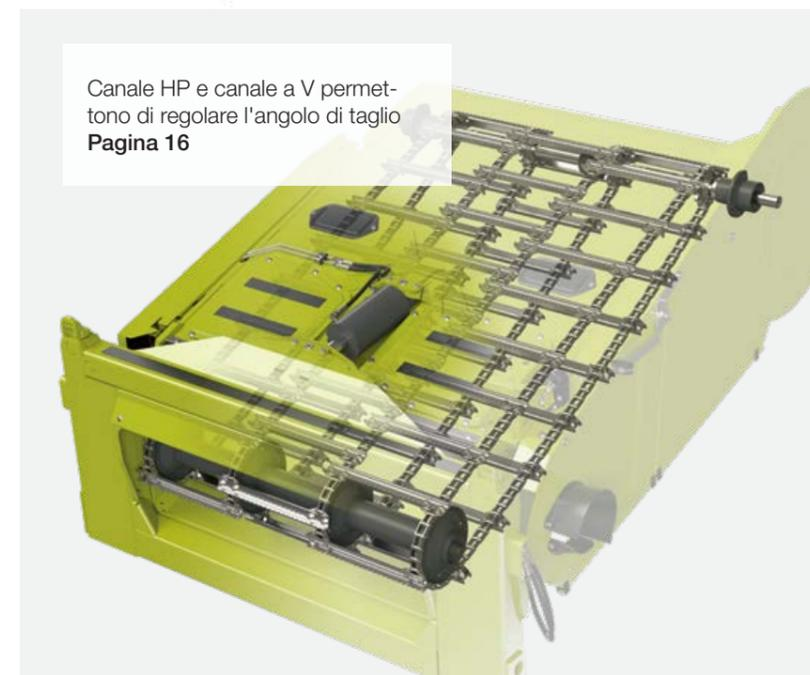
Canale HP e canale a V permettono di regolare l'angolo di taglio.
