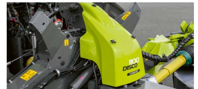
Kompakts un stabils montāžas rāmis ar sērijveidā integrētu ACTIVE FLOAT atslogošanas sistēmu.
