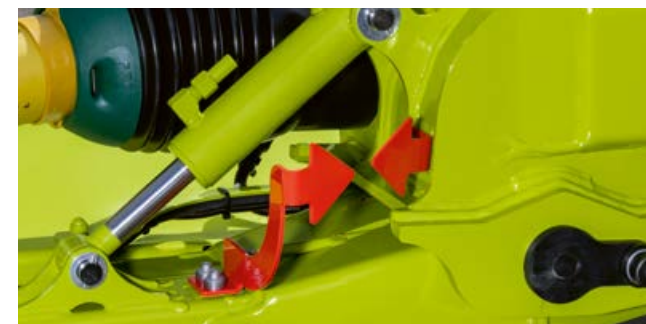
Vienkārša centrālā rāmja augstuma regulēšana: bultu galiem jābūt pavērstiem vienam pret otru.
