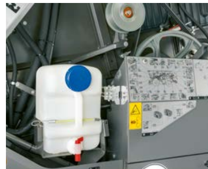
Viegla piekļuve eļļošanas sadales blokiem
