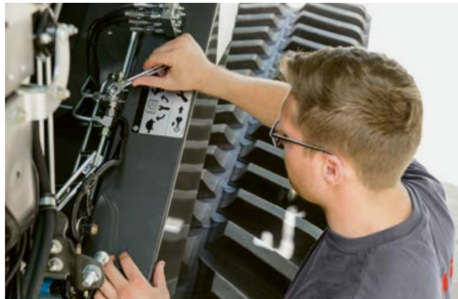
Jūs varat manuāli, izmantojot hidrovārstu, pārslēgties starp diviem kuļtrumļa ātruma regulatora apgriezienu diapazoniem.
