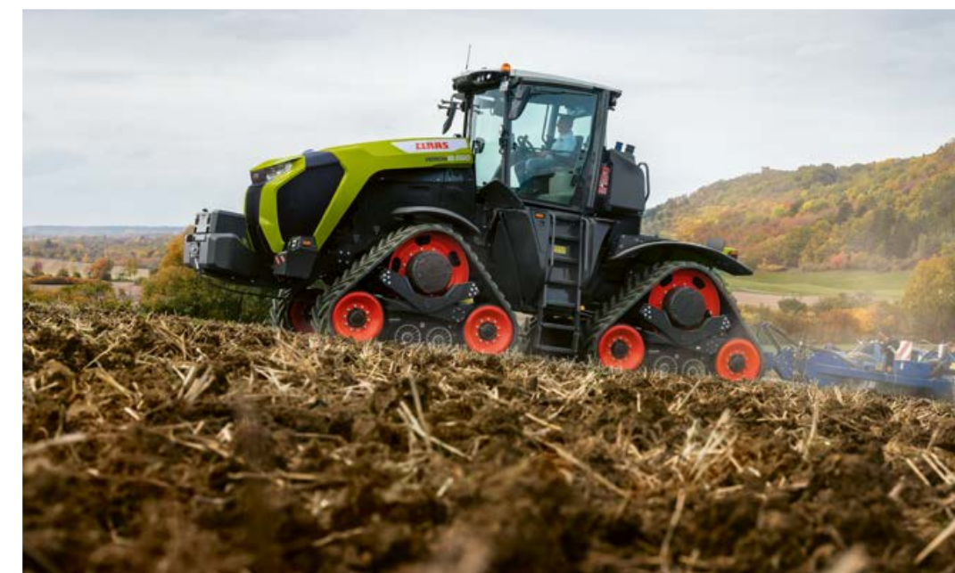
◀ Za wyjątkowo wysoki komfort jazdy ciągnikiem XERION odpowiada koncepcja amortyzacji – począwszy od gąsienic o właściwościach tłumiących drgania, przez 4-punktową amortyzację kabiny, a skończywszy na amortyzowanym fotelu premium.
