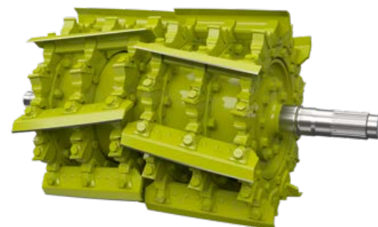
Kaks korda suurema lõikepikkuse saavutamiseks kasutatakse poolt noakogust.
