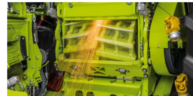
Vastutera teritamine ja reguleerimine toimub väga kiiresti.
