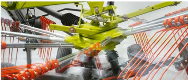
Kardāna tipa rotora piekare nodrošina, ka rotori kopā augsnes reljefu neatkarīgi no traktora.
