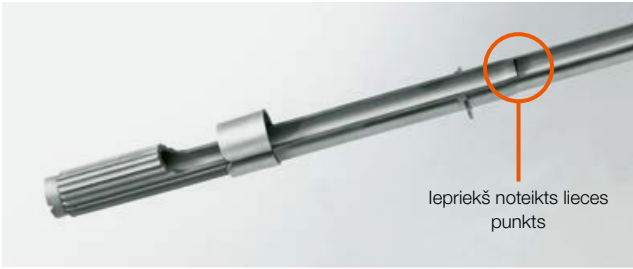
Maksimāla aizsardzība: sadursmes gadījumā zari noteiktajā punktā noliecas.
