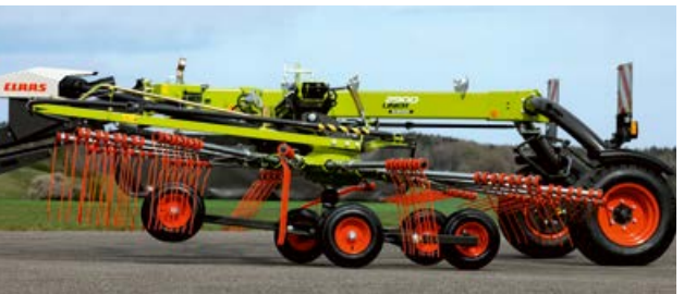
Reaktīva kustība: rotors pacelšanas un nolaišanas laikā uzvedas kā lidmašīna, kas paceļas un nolaižas.
