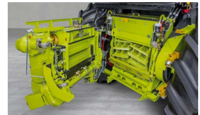
Ērta piekļuve smalcināšanas rotoram, lai to varētu ātri un viegli apkopt.
