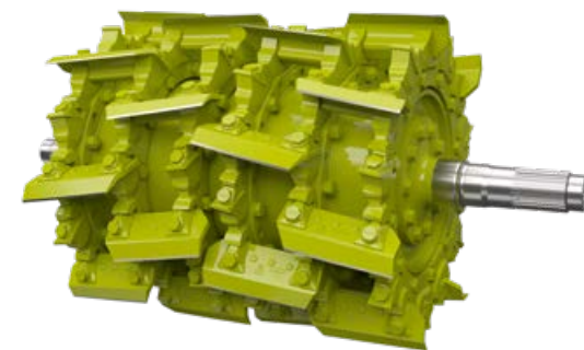
Smalcināšanas dubultgarums, izmantojot pussekciju nažus, kas nodrošina simetrisku augu masas padevi.
