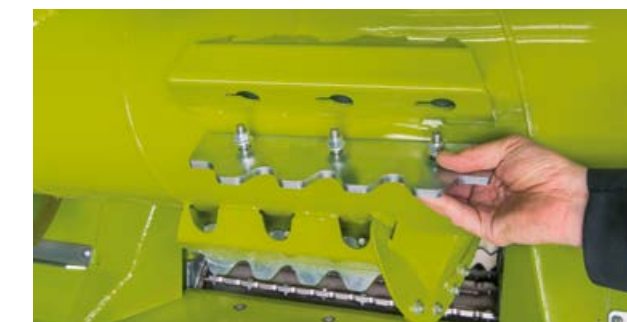
Padeves šneks ar četriem padeves elementiem.
