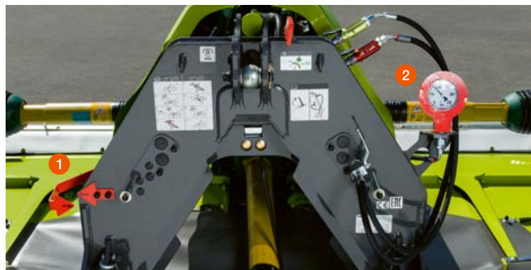
1 niittokorkeuden säätö, 2 ACTIVE FLOAT painemittaria
