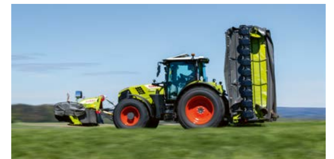
Alle 4 m: tiivis kuljetusasento varmistaa maantiekuljetukset.
