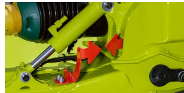
Keskirungon korkeuden helppo säätö: Nuolien kärjet tulee olla vastakkain.
