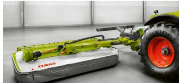
Hydraulisten teleskooppivarsien ansiosta voidaan, etuniittolaitteesta riippuen, saavuttaa 9,40 m - 10,70 m työleveys.
