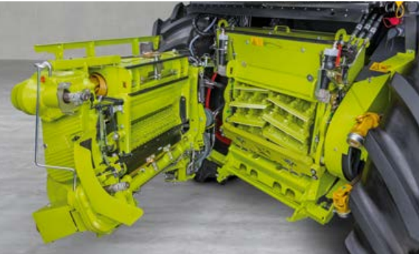
Lengvai pasiekiamas smulkinimo būgnas greitai ir lengvai techninei priežiūrai.
