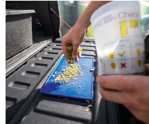
Maissinäyte levitetään kuohkeasti siniselle analysialustalle.
