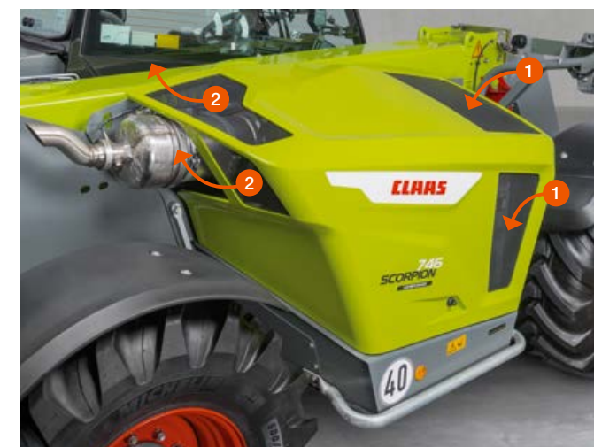
▲ Воздух всасывается спереди в чистой зоне (1) и отводится вверх в задней части (2). Это не пугает животных и одновременно снижает образование пыли.
