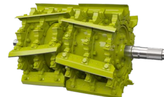
Fördubbling av snittlängden med halva antalet knivar.
