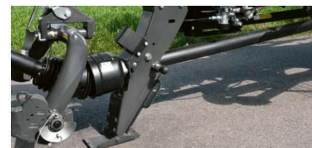
Pé de suporte semiautomático. Todos os encordoadores de quatro rotores LINER dispõem de um pé de suporte semiautomático com uma construção inteligente, que pode ser operado de forma prática, apenas com uma mão.
