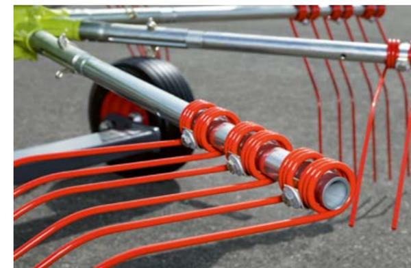
Remoção do suporte de dentes, sem ferramentas.
