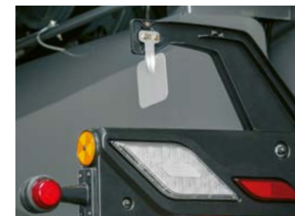
Sensor der automatischen Wurfrichtungsanpassung
