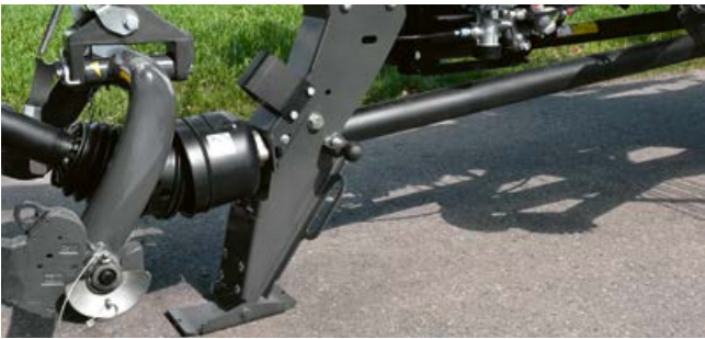
Halvautomatisk støttefod. Alle LINER firerotorriver har en intelligent konstrueret halvautomatisk støttefod, som let kan betjenes med kun én hånd.
