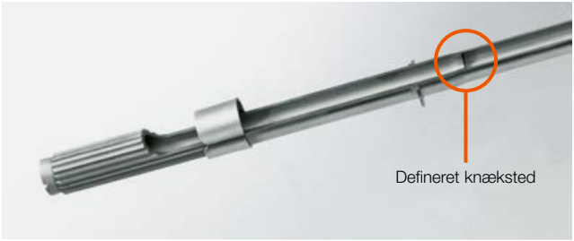
Beskyttet bedst muligt: I tilfælde af kollision knækker armene kontrolleret ind på et defineret sted.
