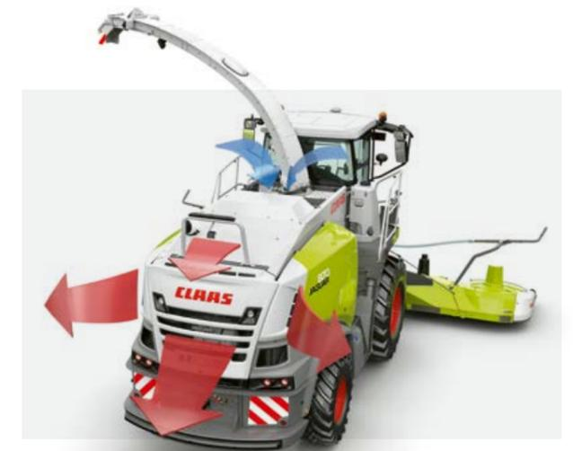
Le compresseur intégré débite 600 l/min à 9,5 bar. Il vous permet d'utiliser un dispositif de freinage de remorque et des outils pneumatiques comme une soufflette pour nettoyer la JAGUAR après le travail.
