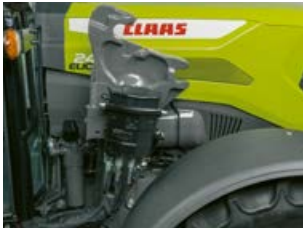
Sistem FITLOCK za priklop in odklop ter hitra spojka MACH za električne in hidravlične povezave.
