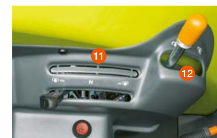
Priključna gred je serijsko opremljena s hidravličnim vklopom. Pri strojih z opremo REVERSHIFT je preklp elektronske priključne gredi na voljo opcjsko.
