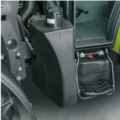
Rezervoar za gorivo prostornine 95 l in 10 l rezervoar za AdBlue sta dovolj velika za dolge in naporne delovne dni.
