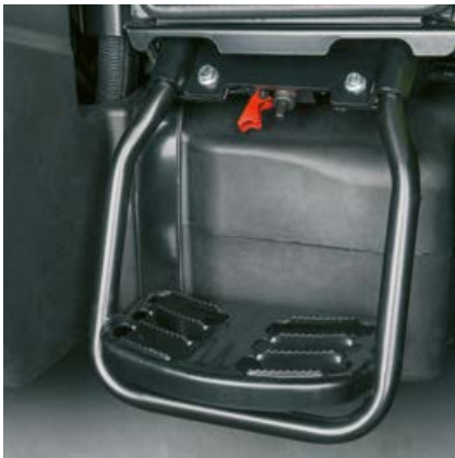
Stikalo za odklop akumulatorja je priročno nameščeno na levi strani stopnic. (razen ELIOS 210)
