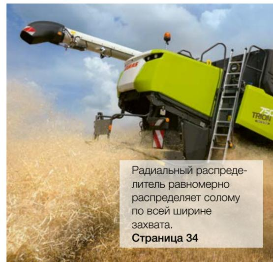
Радиальный распределитель равномерно распределяет солому по всей ширине захвата.
