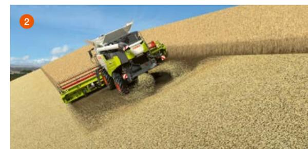
2 Измельченный материал равномерно распределяется по всей ширине захвата.
