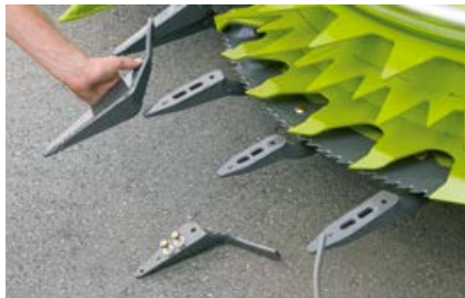
Indføringsfingre, der kan på- og afmonteres, sørger for, at liggende majs løftes bedre.
