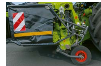
Meget komfortabel kørsel med aktiveret transportsystem, når liftaffjedringen er tilkoblet.
