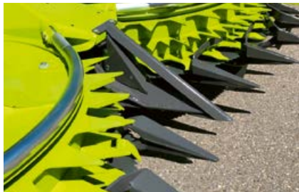
Effektiv afgrødesortering med en smal midterspids til tyndstilkede afgrøder.
