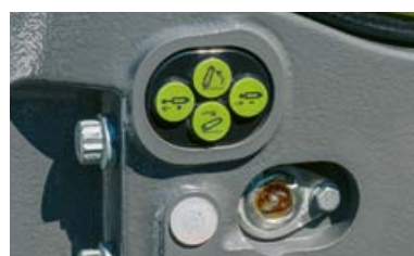
CEBISe versioonil on väline esirippsüsteemi ja ühe hüdrojagaja juhtimine.
