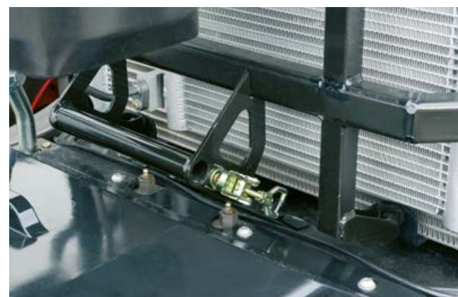
Esisilla määrimispunktid on paigutatud jahutusmooduli ette, et tagada optimaalne ligipääs.
