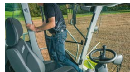
Spínač kontaktu sedadla automaticky vypne sklízňový adaptér a hlavní pohon.
