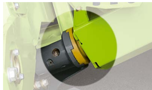
Voimansiirto pikakytkimen avulla.
