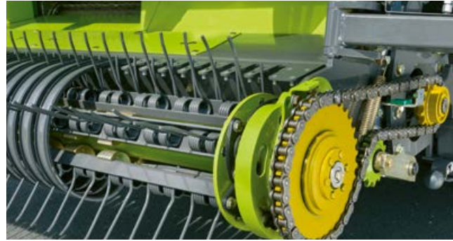
Vahvat noukinpiikit varmistavat puhtaan rehun noston.
