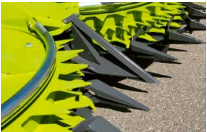
Puhdas kasvuston nosto kapealla keskikärjellä, ohutvartisten kasvilajien korjuuseen.
