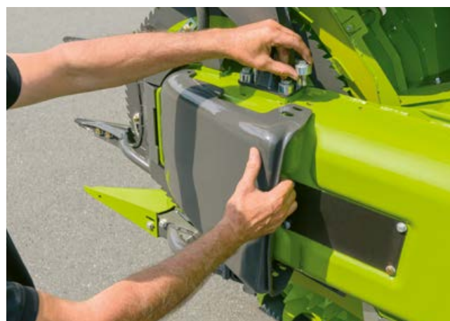
Liukujalaket kaksivaiheisella korkeussäädöllä.
