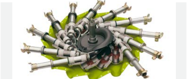
Huoltovapaa luotettavuutta: LINER'in sydän on öljykylvyssä oleva ohjainrata.
