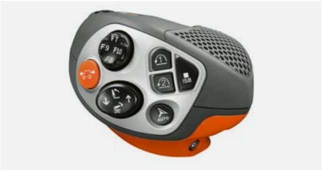
Jada aktiveerimiseks kasutate CMOTIONi sõiduhuoval olevaid F-klahve.
