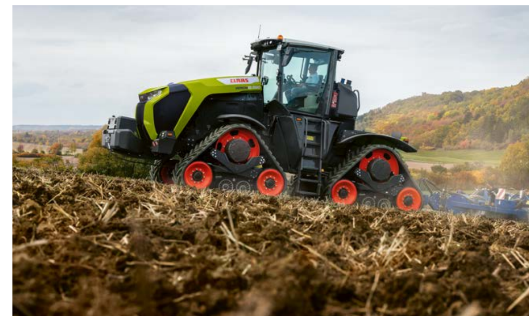
▲ Vedrustuslahendusega, mis hõlmab nii võnkesummutusega roomikut, neljapunktilist kabiinivedrustust kui ka tippklassi kuuluvat vedrustatud istet, tagab XERION eriti kõrgetasemelise sõidumugavuse.
