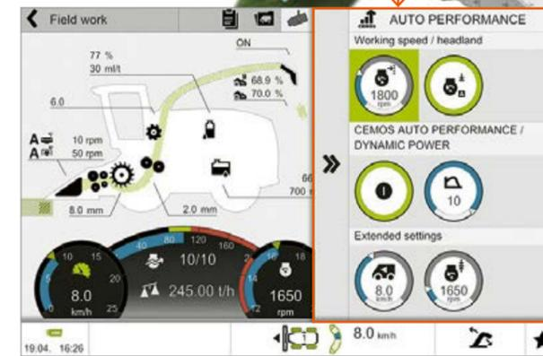
Usted realiza, con CEMOS activado, una cosecha aún más eficiente – son posibles hasta un 7 % más de ha/h con un ahorro de combustible del 12 %. Para incrementar la eficiencia y reducir el consumo, la JAGUAR mantiene constante el régimen de revoluciones ajustado y regula la potencia de motor y la velocidad de avance en base a la masa de cosecha. Cuando aumenta la masa de cosecha, se reduce la velocidad de avance. Con una menor masa de cosecha se reduce automáticamente la potencia del motor.
