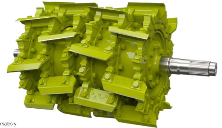
V-FLEX equipado con semicuchillas para doblar las longitudes de corte con una entrega simétrica del material de cosecha.
