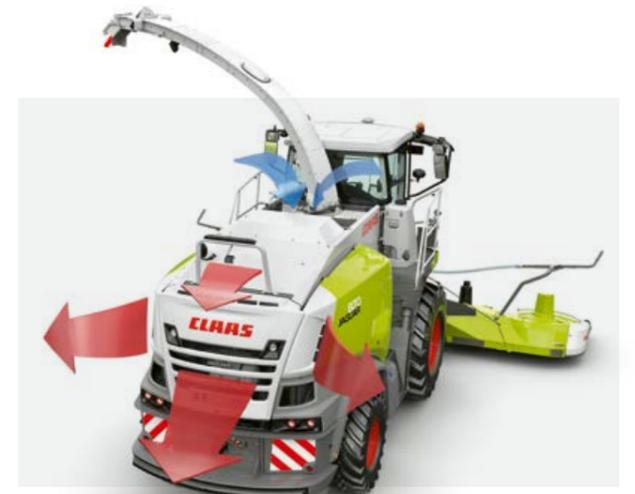
在9.5 bar条件下，集成的压缩机提供600 l/min效率。由此操作拖车制动系统，可以使用空气为动力的工具在作业后吹扫JAGUAR，例如风枪。
