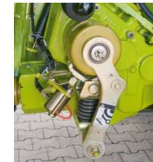
金属探测器关断离合器
