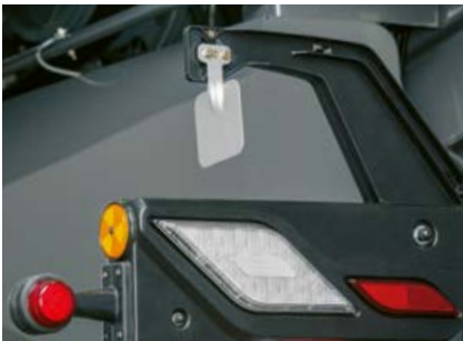
Sensor for automatisk tilpasning af kasteretningen.
