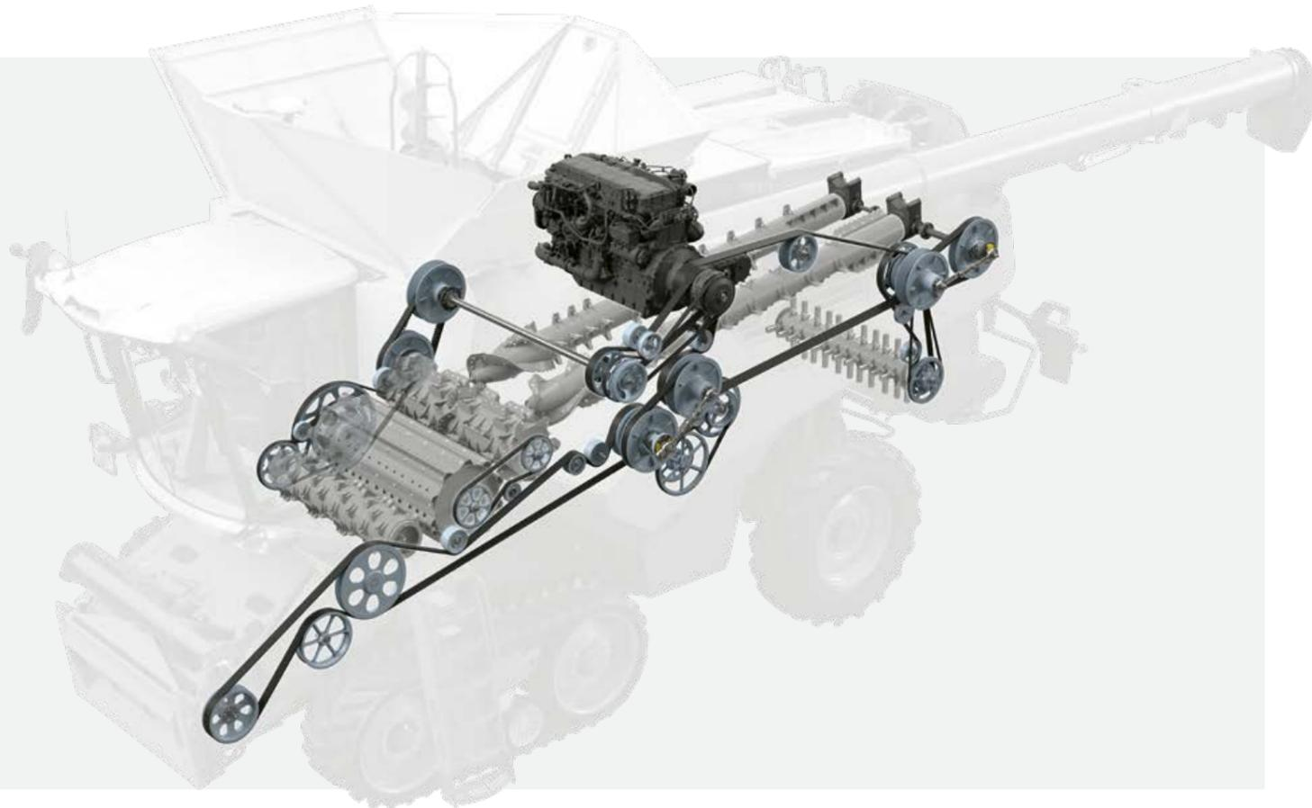
**Propulsión hidrostática hasta 40 km/h.**
