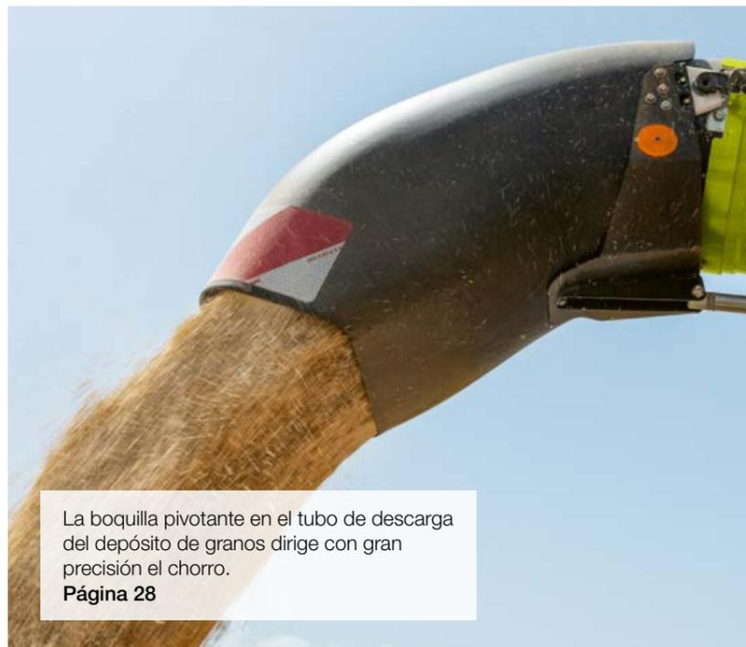
La boquilla pivotante en el tubo de descarga del depósito de granos dirige con gran precisión el chorro.
