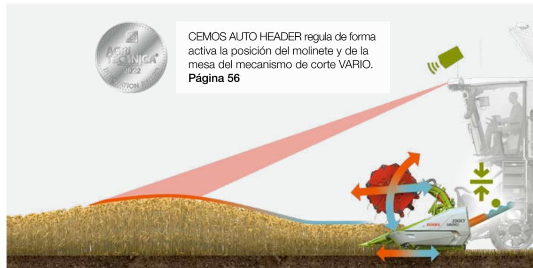
CEMOS AUTO HEADER regula de forma activa la posición del molinete y de la mesa del mecanismo de corte VARIO.
