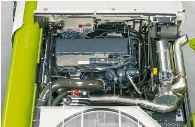
MAN D42 con 581 kW / 790 CV para LEXION 8900
