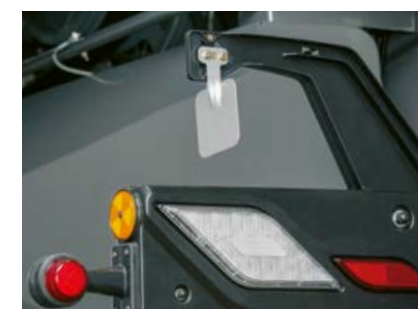
Sensor der automatischen Wurfrichtungsanpassung
