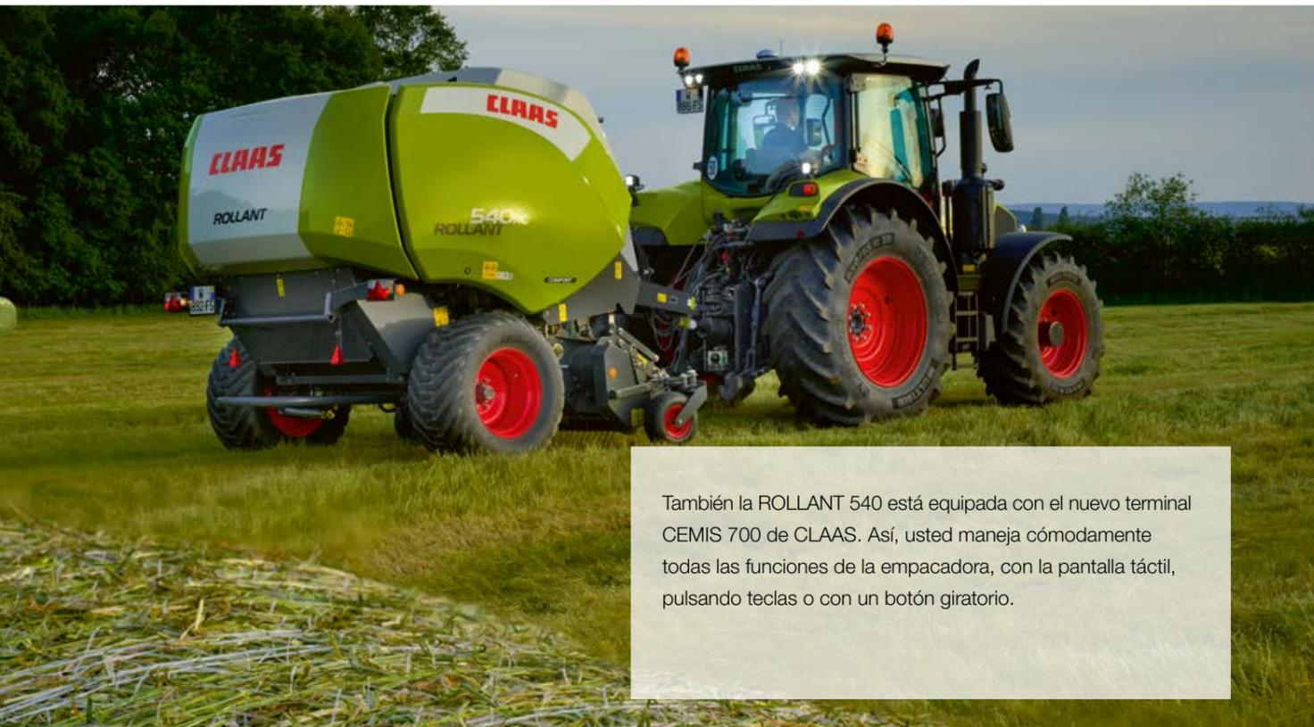
También la ROLLANT 540 está equipada con el nuevo terminal CEMIS 700 de CLAAS. Así, usted maneja cómodamente todas las funciones de la empacadora, con la pantalla táctil, pulsando teclas o con un botón giratorio.
