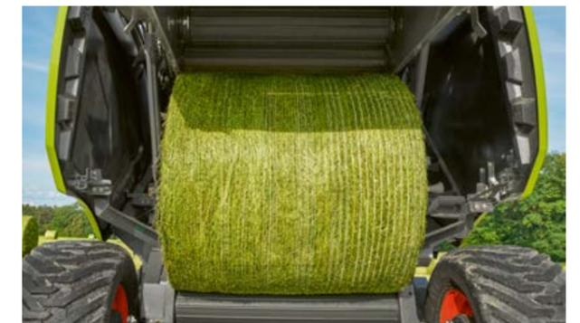
La ROLLANT de CLAAS es la empacadora de cámara fija más vendida en el mundo. Su robusto y acreditado concepto de cámara fija sigue un proceso de desarrollo continuo por parte de nuestros ingenieros. En la ROLLANT 540 se encarga la actual generación con 15 rodillos reforzados, tomas de fuerza con 50 mm de grosor y rodamientos de bolas extremadamente robustos, de ofrecer unas pacas de ensilado perfectas con un flujo de material óptimo.
