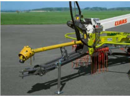
Bară de tracțiune în formă de paralelogram disponibilă opțional pentru modelul LINER 700 TWIN și standard pentru LINER 800 TWIN.
