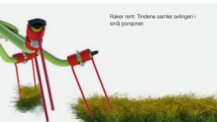
Spredevinkelen kan stilles inn uten verktøy og sørger for ren raking og riktig tilpasning under alle forhold.
