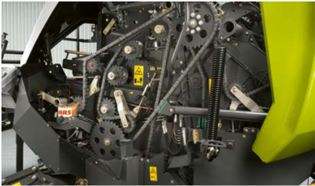
Concetto di trasmissione a risparmio di potenza.
