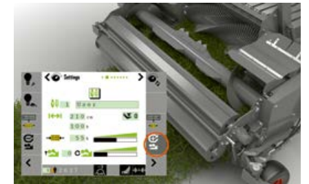
POWER FEEDING SYSTEM on helposti peruutettavissa traktorin ohjaamosta.
