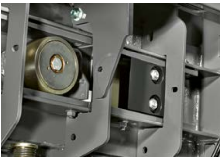
Käännettävät terät voidaan asentaa kahteen asentoon olkia / maissinkorsia tai heinää / säilörehua paalattaessa.
