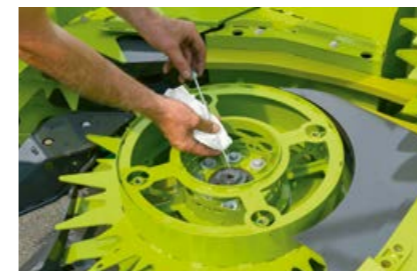
Bagnet pomiarowy do kontroli oleju.
