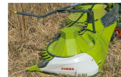
Duży stożek do wyległej kukurydzy optymalizuje przepływ materiału i zapobiega gromadzeniu się zebranych roślin na tarczy transportowej.
