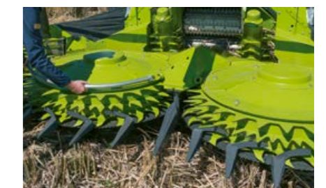
Demontaż chwytacza kolb poprawia przepływ materiału.
