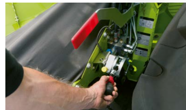
Trójstopniowe dopasowanie liczby obrotów bębnow zasilających dla optymalnego przepływu materiału.
