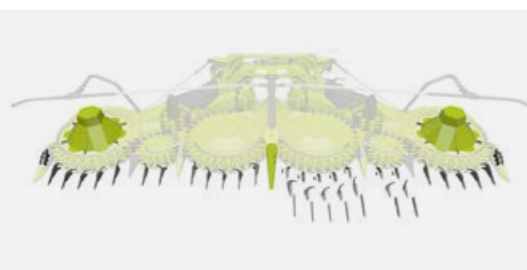
Stożki do wyległej kukurydzy, elementy prowadzące oraz przedłużenia czubków dostępne jako wyposażenie dodatkowe.
