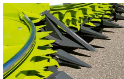
Czysta separacja materiału za pomocą wąskiego czubka środkowego do roślin o cienkich łodygach.
