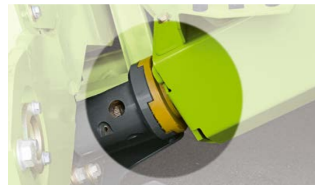
Przeniesienie siły przez szybkozłącza.
