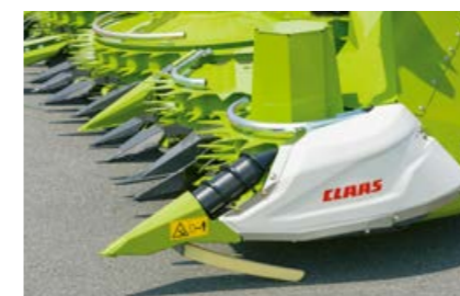
Napędzane hydraulicznie czubki do wyległej kukurydzy.
